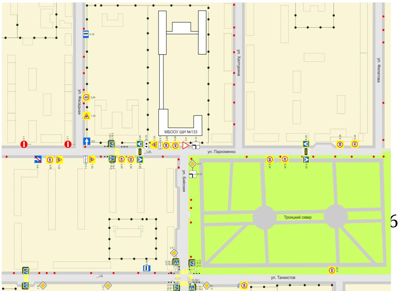
**Схема организации дорожного движения в непосредственной близости от МБОУ ШИ № 133 с размещением соответствующих технических средств, маршруты движения детей и расположение парковочных мест**
